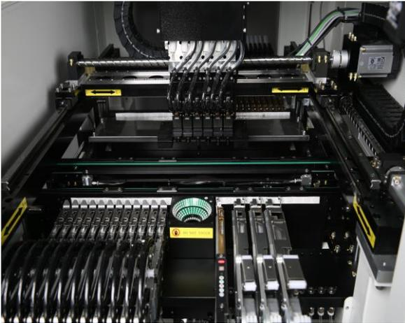
Equipado con un motor servo Panasonic de 400W para garantizar un mejor par y aceleración, logrando un montaje estable y duradero.
