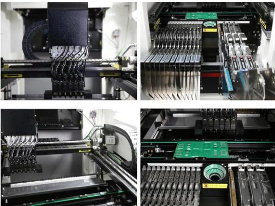
1. Admite tanto alimentadores eléctricos como neumáticos con un máximo de 53 ranuras para alimentadores de bobinas de cinta, con un ancho de máquina de solo 800 mm, para garantizar alta eficiencia con espacio flexible y valioso.
