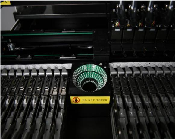
El sistema de reconocimiento de cámara voladora de desarrollo propio utiliza un sensor CMOS importado, una lente de alta definición de nivel industrial de 5 millones de píxeles y 289 fuentes de luz LED en anillo sin sombras, para garantizar efectos estables y duraderos.
