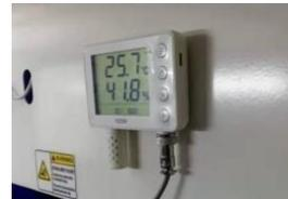
Ajuste automático y supervisión de la temperatura y la humedad dentro de la imprenta, para garantizar las características físicas estables de los materiales de impresión.
