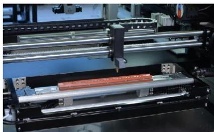
El nuevo sistema de limpieza garantiza un contacto completo con la plantilla; se pueden seleccionar tres métodos de limpieza: en seco, húmedo y al vacío, y se puede realizar una combinación libre; placa de limpieza de goma suave y resistente al desgaste, limpieza completa, desmontaje conveniente y longitud universal de papel de limpieza.
