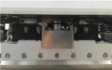
Sistema de control integrado con un sensor de presión digital preciso, a través del sistema de retroalimentación de presión de la rasqueta, puede mostrar con precisión el valor de presión original de la rasqueta, ajustar inteligentemente la profundidad de presión de la cuchilla hacia abajo para asegurar que el valor de presión sea constante durante el proceso de impresión y obtener el control de proceso más alto, logrando una impresión perfecta de dispositivos de alta densidad y espaciado fino.
