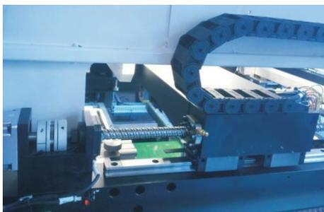
El eje Y de la rasqueta adopta el accionamiento del servo motor a través de un sistema de transmisión de tornillo, para mejorar la precisión, la estabilidad operativa y extender la vida útil, proporcionando a los clientes una plataforma de control de impresión sólida.
