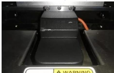
La altura de la plataforma se calibra automáticamente según la configuración del grosor del PCB, lo que es inteligente, rápido y tiene una estructura simple y confiable.
