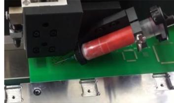
De acuerdo con los diferentes requisitos del proceso de impresión, después de la impresión, el PCB puede llevar a cabo una dispensación precisa, dispensación de estaño, dibujo de líneas, llenado y otras operaciones funcionales.
